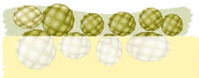
Representación aumentada de los granates en el barrillo abrasivo
