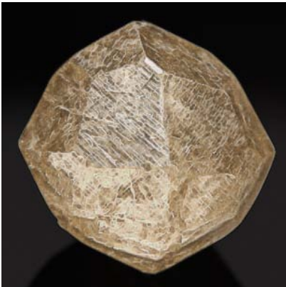
Una gran ampliación: un cristal de espesartina, también conocido como "granate". Estas son las partículas abrasivas que dan a las cotículas sus propiedades únicas.
